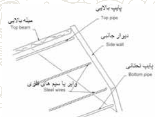
تصویر - 14: نصب سیستم عایق شبانه در گلخانه
