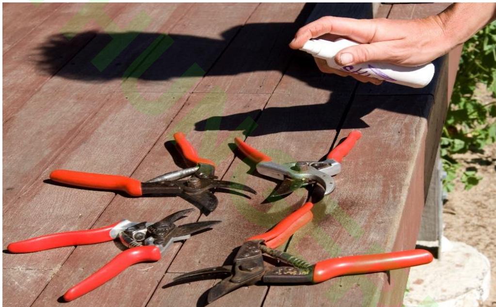
شکل ۴: ضدعفونی کردن ابزار برش
