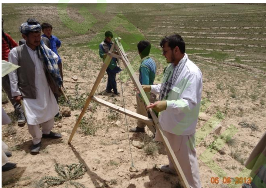
تصویر ۱۶: از چوکات A می‌توان برای ساخت تراس‌ها و تراز کردن زمین استفاده کرد.
